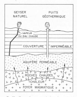
Fig. 1. — Profil d'un gisement géothermique (schématique d'après Teerink) [19].
