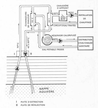
Fig. 3. — Schéma d'une centrale géothermique destinée au chauffage urbain.
