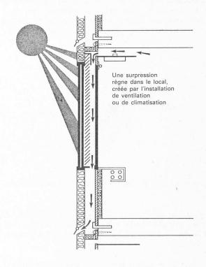
Fig. 3. — Elément climatique de façade type « Protecta-Sol »
