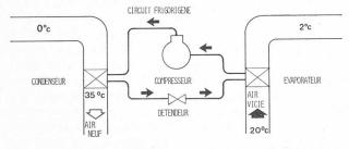
Fig. 5. — Schéma simplifié de pompe à chaleur sur l'air extrait.
