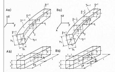
Fig. 2. — Deux membres de la famille d'éléments spatiaux de barre-courbe de section rectangulaire variable (a) et leurs éléments de base (b): élément quadratique (A), élément cubique (B).
