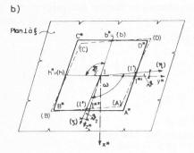
Fig. 4. — Projection de la section  $\zeta = \zeta_I$  sur le plan perpendiculaire à l'axe et détermination des axes locaux  $x^*$ ,  $y^*$  et  $z^*$ .
