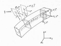
Fig. 3. — Section  $\zeta = \text{const.}$  et section perpendiculaire à l'axe en un point intermédiaire de l'élément.
