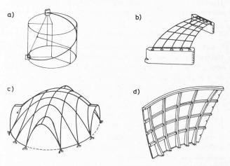
Fig. 1. — Exemples de constructions formées d'éléments spatiaux de barres courbes : a) poutre hélicoïdale, b) pont courbe (grille), c) coupole, d) coque nervurée.
