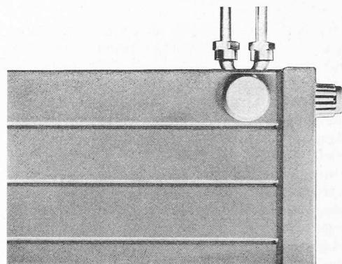
La vanne incorporée Runtal est une véritable vanne à quatre voies, dans laquelle le débit dans la vanne et par conséquent dans le circuit est indépendant du réglage de la vanne. Celle-ci est prévue pour les dimensions de tube : 10/12 - 12/14 - 13/15 - 14/16 mm, une température de service de 100°C max. et une pression nominale de 6 kg/cm<sup>2</sup> max.
