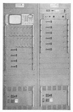
Fig. 4. — Station de tête professionnelle Fuba équipée de 10 programmes TV et 12 OUC, ainsi que des instruments de contrôle.
