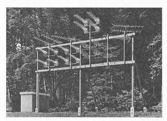
Fig. 2. — Montage sur cadre permettant de se protéger des perturbations venant de l'arrière.
