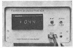
Sur demande des sondes spéciales sont disponibles par exemple avec un thermocouple incorporé mesurant la température et le flux de chaleur en un même point.
