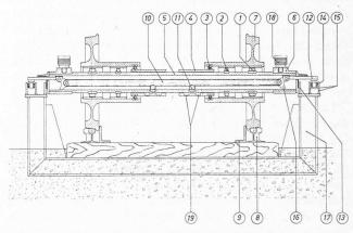
Fig. 1. — Coupe schématique de l'essieu à l'écartement normal (1435 mm).
