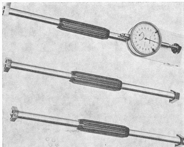
Cet instrument se compose d'une barre en invar aux extrémités de laquelle se trouvent deux têtes pourvues de pieux coniques, dont l'un est fixe, tandis que l'autre peut effectuer une petite rotation autour de son axe perpendiculaire à la barre par l'intermédiaire de microroulements.
