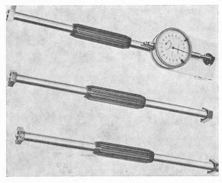
Cet instrument se compose d'une barre en invar aux extrémités de laquelle se trouvent deux têtes pourvues de pieux coniques, dont l'un est fixe, tandis que l'autre peut effectuer une petite rotation autour de son axe perpendiculaire à la barre par l'intermédiaire de microroulements.
