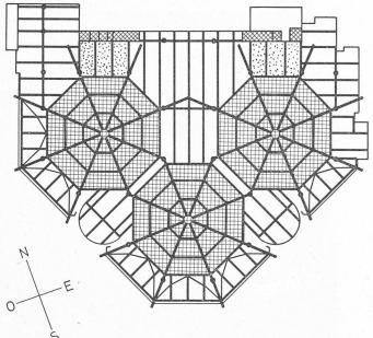
Fig. 1. — Structure de la toiture.
