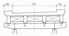
Coupe-type sur culée ou portée. Surcharge : Convoi de 103,5 tonnes, composé d'un tracteur plus remorque chargée d'un blindé de 50 tonnes.
