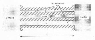
Fig. 14. — Modèle à faisceau de tubes (d'après H. J. Morel-Seytoux, 1969).
