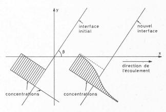
Fig. 12. — Dispersion de l'interface dans un écoulement d'orientation quelconque (d'après J. Bear, 1969).
