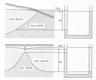
Fig. 5. — Equilibre hydrostatique de Ghyben et Herzberg.
