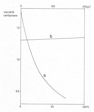
Fig. 4. — Variation de la viscosité de l'eau avec la température (a) et avec la teneur en NaCl (b).
