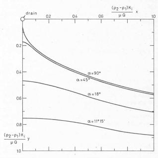
Fig. 10. — Interface sous un drain dans un aquifère infini (d'après J. Bear et G. Dagan, 1964).
