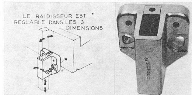
Destinée à la fixation des garde-corps en nez de dalle et des remparts contre le limon ou l'escalier, cette platine augmente la surface utile de l'escalier ou du palier et supprime l'habillage de l'acrotère. L'intérêt du système est de permettre de prolonger le garde-corps du balcon devant le nez de dalle et d'utiliser les panneaux de remplissage comme brise-soleil des niveaux inférieurs.
