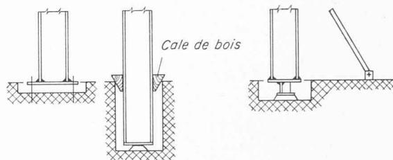
Poteau tenu à l'aide de boulons d'ancrage ou posé dans l'évidement de fondation.
