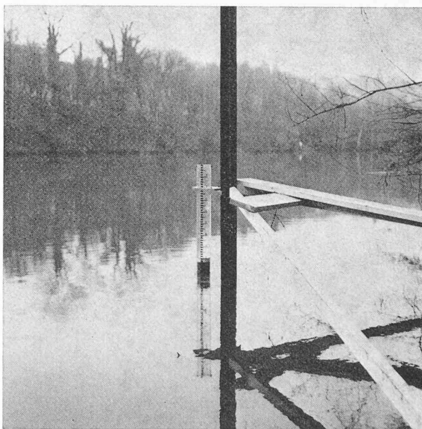
Fig. 6. — Vue d'un limnimètre à flotteur utilisé pour la mesure du battillage.
