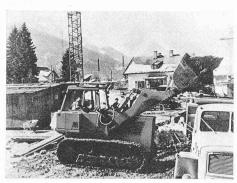
Les pelles et niveleuses K 12 d sont dès maintenant dotées d'un moteur diesel Hanomag série D 900, 6 cylindres et 9500 cc de cylindrée, puissance maximale 140 ch DIN/160 chSAE ou 103 kW à 2200 tours/minute. Il s'agit donc d'un vrai moteur de machine de chantier à faible course et vitesse moyenne du piston, travaillant sans problèmes même dans des déclivités importantes. Un nouveau système d'injection assure une consommation de carburant très économique.
