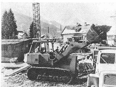
Les pelles et niveuses K 12 d sont dès maintenant dotées d'un moteur diesel Hanomag série D 900, 6 cylindres et 9500 cc de cylindrée, puissance maximale 140 ch DIN/160 chSAE ou 103 kW à 2200 tours/minute. Il s'agit donc d'un vrai moteur de machine de chantier à faible course et vitesse moyenne du piston, travaillant sans problèmes même dans des déclivités importantes. Un nouveau système d'injection assure une consommation de carburant très économique.
