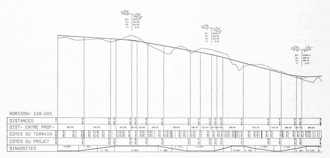
Fig. 5. — Profil en long complet.
