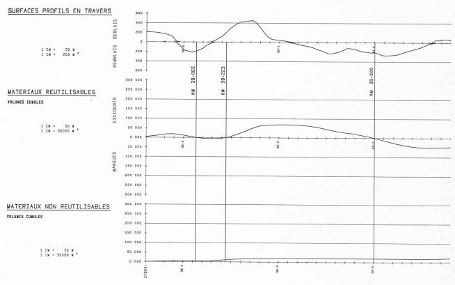
Fig. 8. — Surfaces et volumes en fonction du kilométrage.
