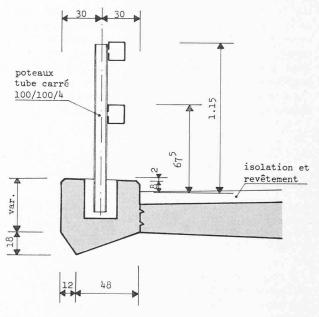
Fig. 4. — Bordure de pont d'autoroute Bordure extérieure en béton coulé sur place
