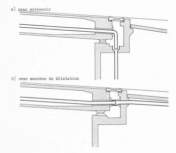
Fig. 7. — Evacuation des eaux — Dispositifs de dilatation aux culées
