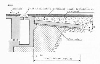
Fig. 3. — Transition pont/route — Ponts avec culées (revêtement bitumeux)
