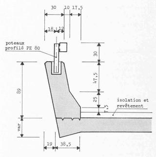
Fig. 5. — Bordure de pont d'autoroute — Mur parapet
