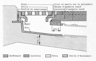
Fig. 6. — Evacuation des eaux — Grille d'écoulement
