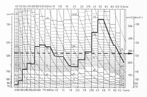
Fig. 5. — Exemple du calcul de la sonie par la méthode de Zwicker pour un bruit à bande large, dans le cas d'un champ libre de 80 à 110 dB.
