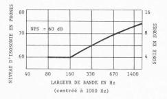
Fig. 3. — L'effet de la largeur de bande sur la sonde est mis en évidence en présentant un son (bruit blanc filtré) à un niveau de pression sonore constant (60 dB) et en augmentant la largeur de bande (centrée à 1000 Hz dans ce cas).
