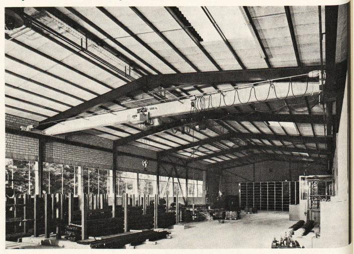
Les pont-roulants monopoutres standard BRUN sont entièrement éxécutés avec des éléments normalisés de notre propre fabrication.
