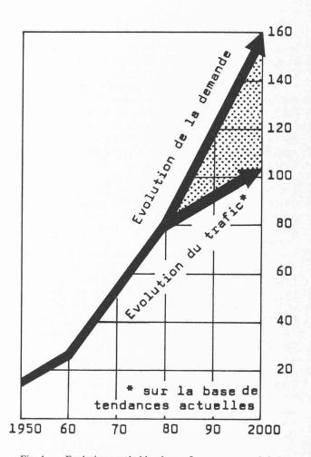
Fig. 1. — Evolution probable du trafic voyageurs global en Suisse de 1950 en l'an 2000, exprimé en voyageurs-km. La zone grisaillée représente le manque de moyens qu'il faut attendre à partir de 1980, du fait que la demande dépassera l'offre.
