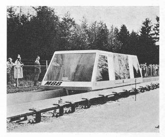
Fig. 27. — Train à suspension magnétique système Messerschmitt-Bölkow-Blohm.
