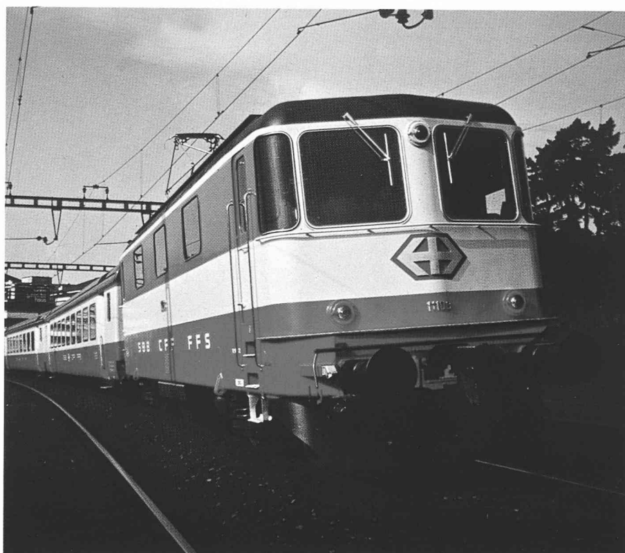
Fig. 12. — Rame automotrice de banlieue 3320 CV, 125 km/h.
