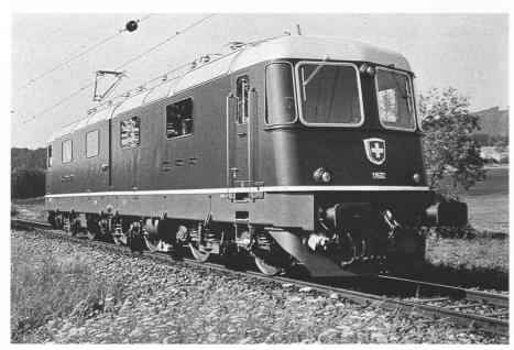
Fig. 11. — Locomotive Re 6/6 pour trains directs et de marchandises: 10 600 CV, 140 km/h.
