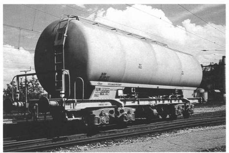
Fig. 18. — Wagon spécial avec des récipients se vidant par air comprimé.
