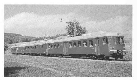
Fig. 12. — Rame automotrice de banlieue 3320 CV, 125 km/h.
