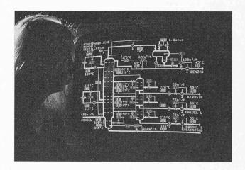
Console graphique 3976 pour l'affichage en sept couleurs de données alphanumériques et de tracés graphiques, lié à un ordinateur. Un dispositif de repérage permet d'intervenir à partir de la console sur le déroulement de processus en cours de traitement par l'ordinateur.
