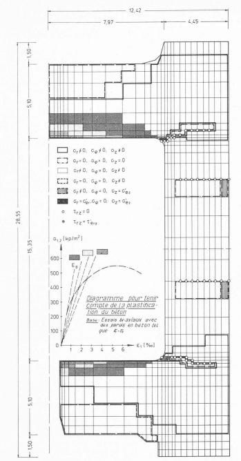
Fig. 14. — Enceinte THTR: contrôle de la capacité portante.
