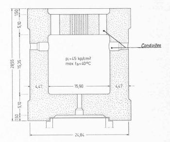
Fig. 1. — Enceinte de réacteur THTR 300 MWe en béton précontraint : section transversale.
