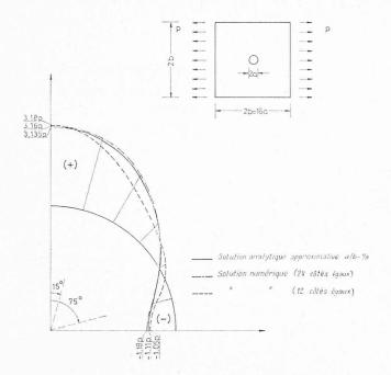
Fig. 3. — Paroi avec ouverture circulaire: contraintes sur le bord du trou (comparaison calcul numérique — solution analytique).
