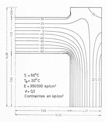
Fig. 9. — Contraintes  $\sigma_{\varphi}$  dues à la température, sans fluage.
