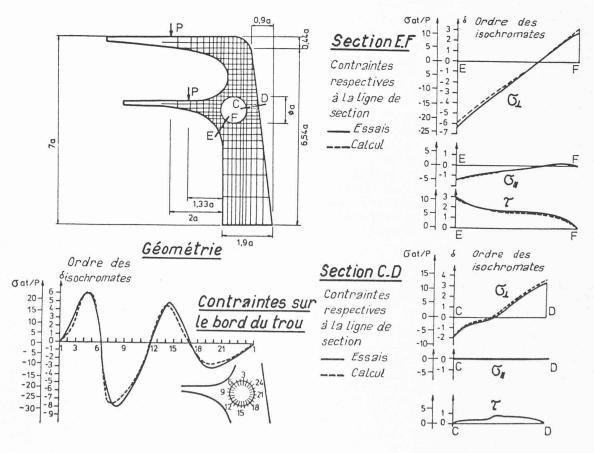
Fig. 7. — Plongeoir, géométrie et répartition des contraintes.
