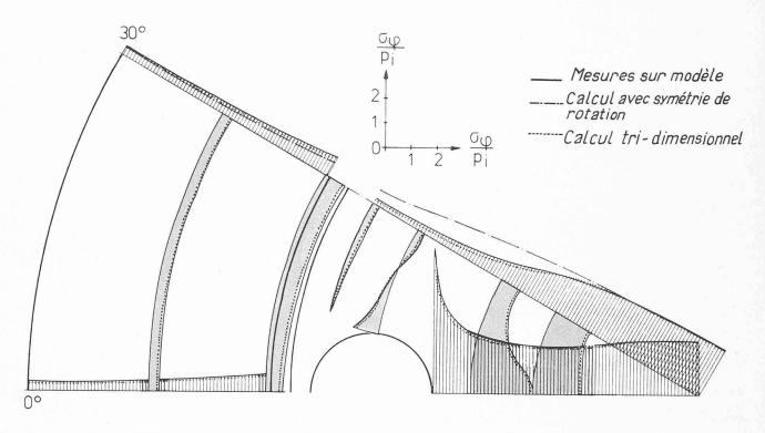
Fig. 6. — Enceinte THTR : modèle 1 : 47 sous pression interne, contraintes tangentielles  $\sigma_{\theta}$  sur la face extérieure de la dalle de couverture.
