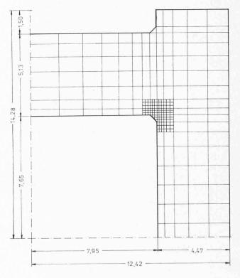
Fig. 5. — Exemple d'une division variable du réseau.
