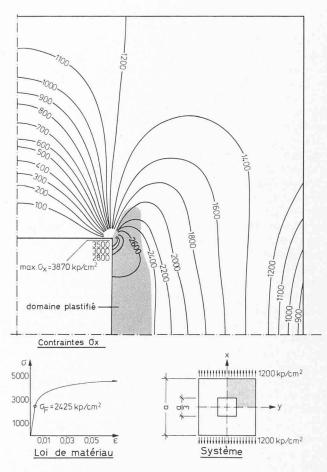
Fig. 11. — Paroi calculée élastoplastiquement présentant une ouverture carrée.
