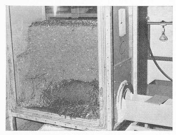
Fig. 3. — Tuyau enterré plus filtre-paille.
