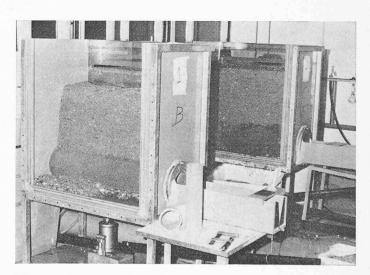
Fig. 2. — Tuyau enterré en sol graveleux.
