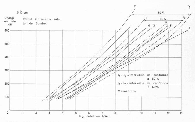
Fig. 5. — Débit en fonction de la charge. Tuyaux « Filtra » nus à écoulement libre, remplissage partiel. Tuyaux immergés, sans sol.
