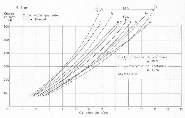
Fig. 4. — Débit en fonction de la charge. Tuyaux «Filtra» nus à écoulement libre, coulant plein. Tuyaux immergés, sans sol.
