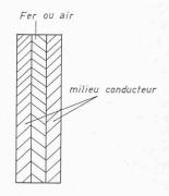
Fig. 4. — Induit de type sandwich.
