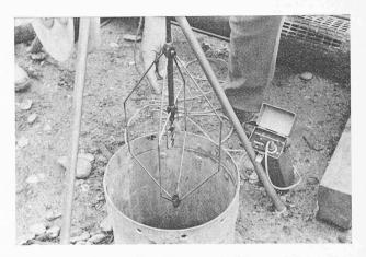
Fig. 10. — Micromoulinet à axe vertical à compte-tours électronique pour la mesure des vitesses ascensionnelles dans les puits de pompage (Solétanche).
