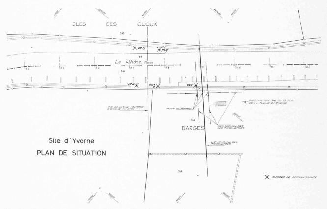
Fig. 5. — Essais de pompage au site d'Yvorne. Disposition de la station d'essai et des piézomètres.
