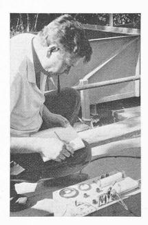
Fig. 12. — Mesure de la résistivité des eaux souterraines par « Géoconsult » (R. Treyvaud).
