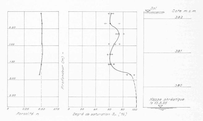
Fig. 19. — Porosité et degré de saturation du sol en dessus de la nappe au site d'Yvorne.
