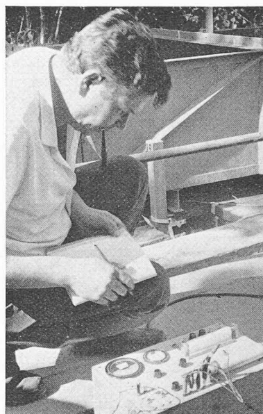
Fig. 12. — Mesure de la résistivité des eaux souterraines par « Géoconsult » (R. Treyvaud).
