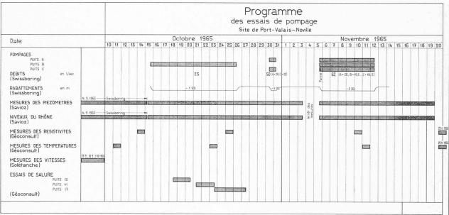
Fig. 6. — Programme des essais de pompage et des mesures. Sites d'Yvorne et de Port-Valais.
