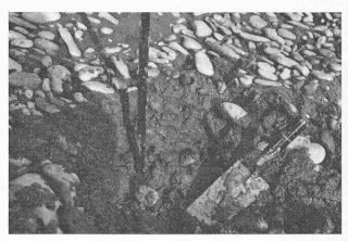
Fig. 15. — Structure ouverte perméable dans les alluvions tapissant le lit du Rhône (Port-Valais).
