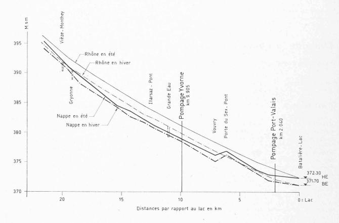
Fig. 2. — Profil en long du Rhône et de la nappe aquifère entre km 22 et le lac.
