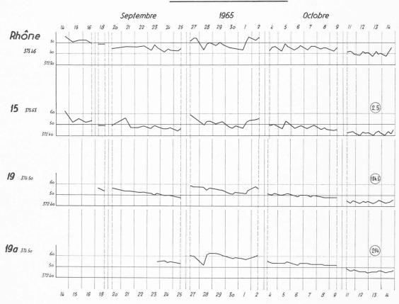
Fig. 17. — Corrélation entre les variations du niveau du Rhône et celles de la nappe à distance croissante du fleuve. Sites d'Yvorne et de Port-Valais.
