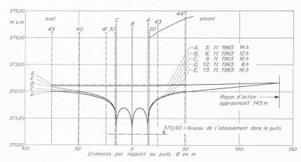
Fig. 7. — Profil en long de la nappe à la station d'essai de Port-Valais. Avant et durant le pompage.
