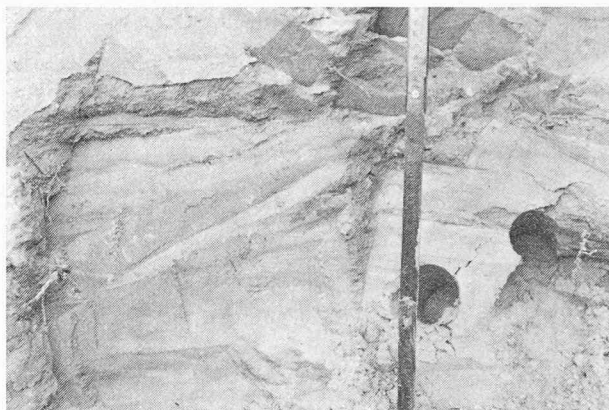
Fig. 14. — Prélèvement dans le limon pour essai de perméabilité sur échantillon non dérangé.
