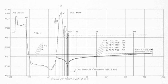
Fig. 8. — Profil en travers de la nappe aux stations d'essai d'Yvorne et de Port-Valais — avant et après pompage. Remarquer la réaction du piézomètre sur rive opposée (R.D.) à Yvorne.
