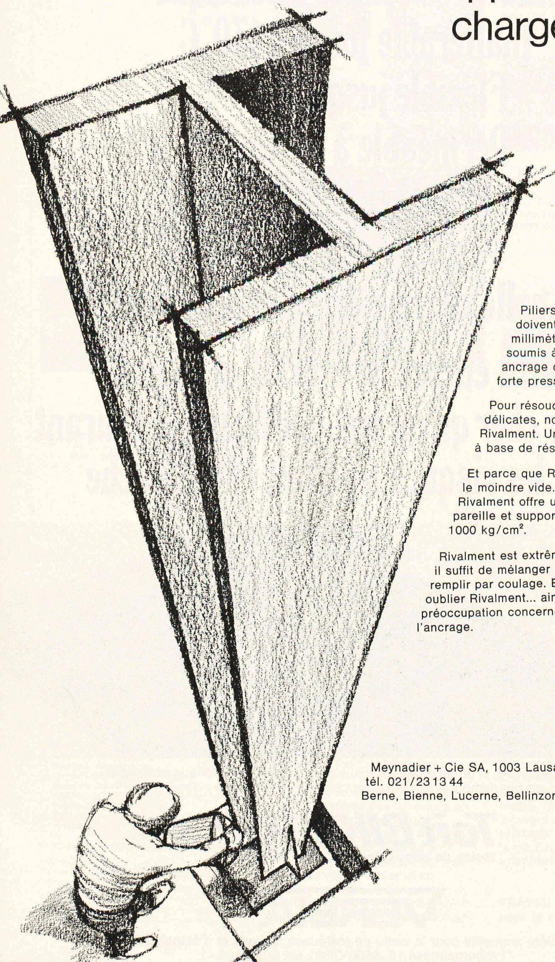
Piliers, poutres, appuis de ponts doivent souvent être ancrés au millimètre près. En plus, ils sont soumis à des charges exigeant un ancrage capable de soutenir une forte pression constante.
