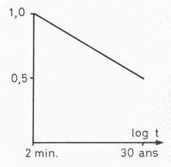
Fig. 2. — Charge de rupture en fonction de la durée d'application.
