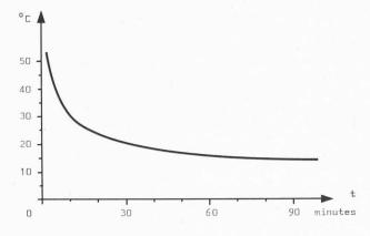
Fig. 5. — Pot life en fonction de la température des supports.
