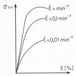
Fig. 1. — Courbes  $\sigma$ - $\varepsilon$  pour différentes vitesses de déformation.
