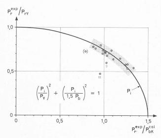
Fig. 6. — Valeurs des charges de ruine des essais rapportées aux valeurs calculées de la plastification de l'aile  $P_{ryk}^{\rm cal}$  et du voilement de l'âme  $P_{bk}^{\rm cal}$ . Charge  $P_i$  pour l'influence réciproque.
