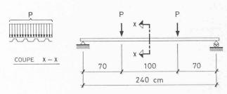
Fig. 1. — Position des charges lors des essais.
