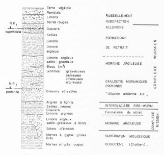
Fig. 1. — Profil type de la cuvette genevoise.
