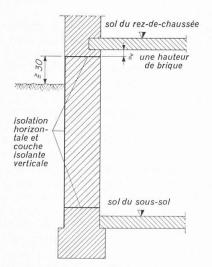
Fig. 1. — Couches isolantes dans les constructions avec souterrain (d'après Karl Lufsky, Berlin).
