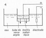
Fig. 3 et 4. — Electro-osmose dans l'essai. Figure 3 montre l'ascension de l'eau (contre la pesanteur) en direction de la cathode. Figure 4 fait voir la situation après le changement du circuit. L'eau descend à travers le bouchon d'argile, également en direction de la cathode.
