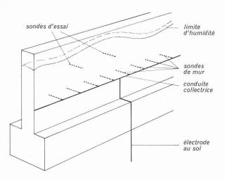
Fig. 7. — Schéma d'une disposition électro-osmotique brevetée.
