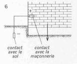
Fig. 5 et 6. — Electro-osmose dans la maçonnerie. La différence du potentiel souvent constatée entre le sol et le mur produit une montée de l'eau dans le mur. Par le court-circuit mur-sol (fig. 6), la direction du mouvement d'eau est inversée.
