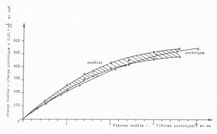
Fig. 12. — Vérification de la relation charge-flèche.
