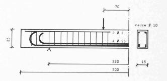
Fig. 11. — Schéma du ferraillage du prototype.
