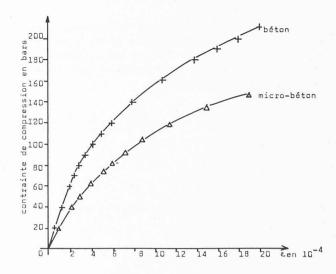
Fig. 7. — Diagrammes contraintes-déformations pour  $C = 400 \text{ kg/m}^3$ .
