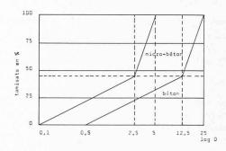
Fig. 3. — Composition du béton et du micro-béton.
