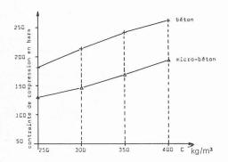
Fig. 4. — Variation de  $\sigma'_7$  avec le dosage en ciment.
