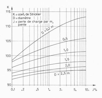
Fig. 5. — K = f(J et D) pour une rugosité k = 0,1 mm.
