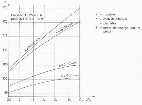
Fig. 3. — K = f(J) pour différentes rugosités.
