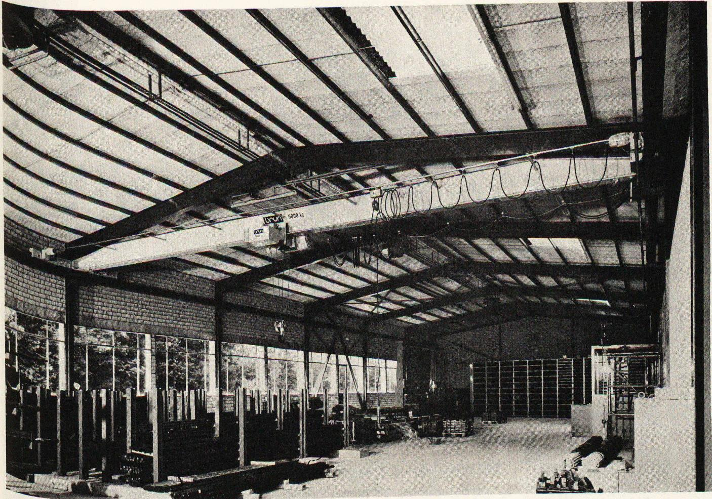
Les ponts-roulants monopoutres standard BRUN sont entièrement exécutés avec des éléments normalisés de notre propre fabrication.
