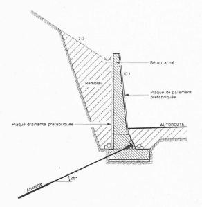
Fig. 5. — Murs poids à semelle ancrée. Coupe.
