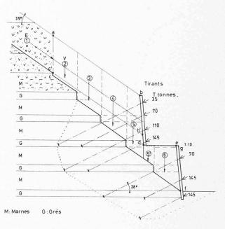
Fig. 9. — Murs à contreforts ancrés. Schéma de rupture.
