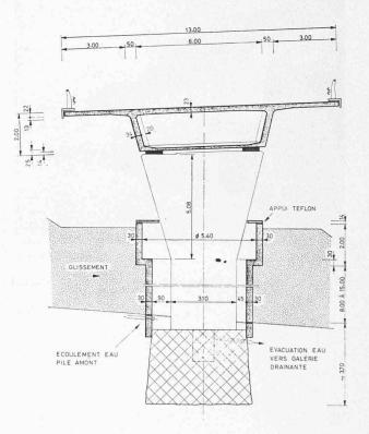
Fig. 2. — Coupe transversale des ponts.
