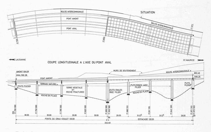
Fig. 3. — Ponts et estacade du Crau-Coulet (situation et coupe longitudinale).
