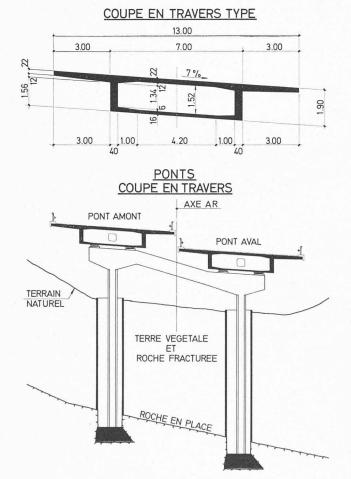
Fig. 4. — Ponts et estacade du Crau-Coulet (coupes transversales).
