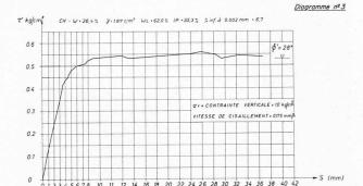
Fig. 10. — Résistance au cisaillement résiduelle.
