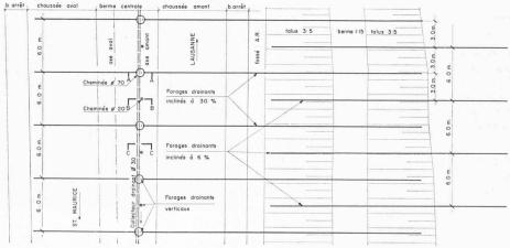
Fig. 16. — Disposition du réseau de drainages.
