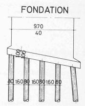
culées fondées sur pieux. Seule la culée côté Lausanne a pu être fondée sur le terrain sans l'intermédiaire de pieux.
