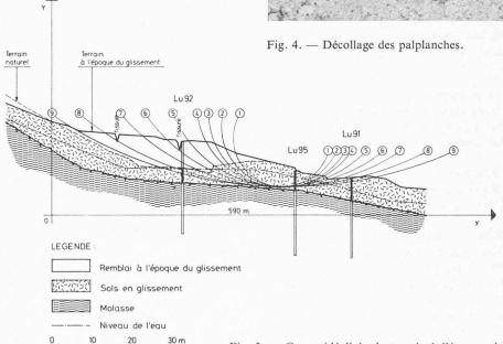
Fig. 5. — Coupe idéalisée du terrain à l'époque du glissement.
