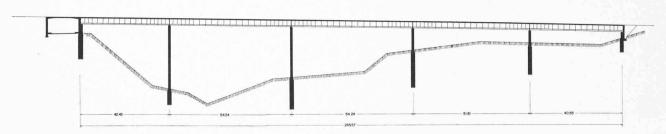
Fig. 2. — Coupe longitudinale du pont aval.
