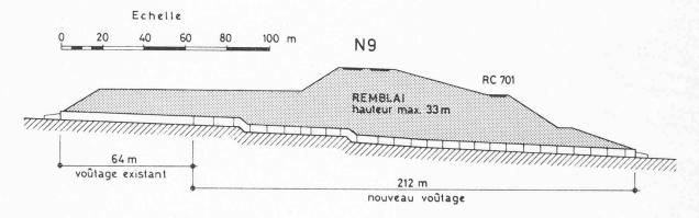
Fig. 3. — Profil en long de l'ouvrage.
