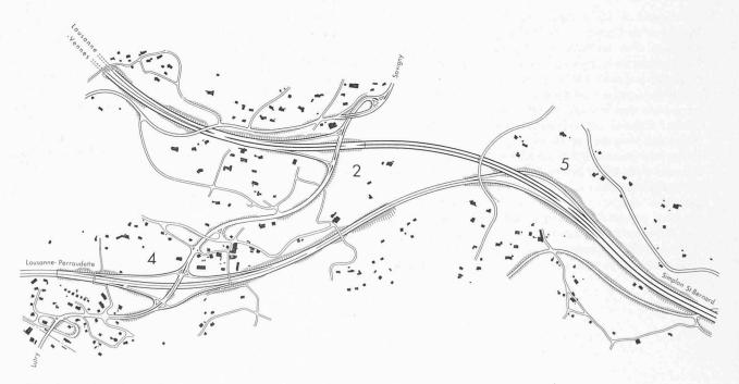
Fig. 3. — Complexe de Lutry comprenant la demi-jonction de Belmont (2), la jonction de Lutry (4) et l'échangeur de La Croix-sur-Lutry (5).
