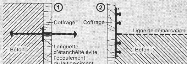
\*DR: pour joints de dilatation, encastrement au bord en béton AR: pour joints de bétonnage, encastrement au bord en béton DK: pour joints de dilatation, encastrement dans les éléments AK: pour joints de bétonnage, encastrement dans les éléments
