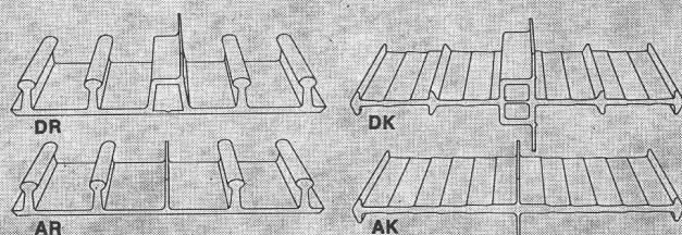
\*DR: pour joints de dilatation, encaissement au bord. AR: pour joints de bétonnage, encaissement au bord. DK: pour joints de dilatation, encaissement dans les éléments en béton. AK: pour joints de bétonnage, encaissement dans les éléments en béton.
