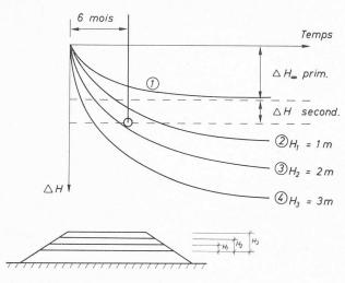
Fig. 14. — Calcul des tassements en fonction du temps pour diverses surcharges de remblai et choix d'une hauteur de surcharge. A titre d'exemple, la durée d'application de la surcharge, compatible avec le programme de construction, a été admise à six mois.
