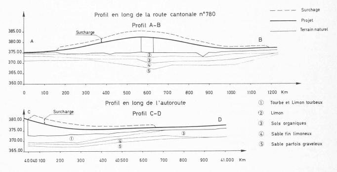
Fig. 13. — Profils en long du remblai d'accès de l'autoroute au viaduc de Villeneuve et des remblais de la route cantonale nº 780 donnant accès au passage supérieur.
