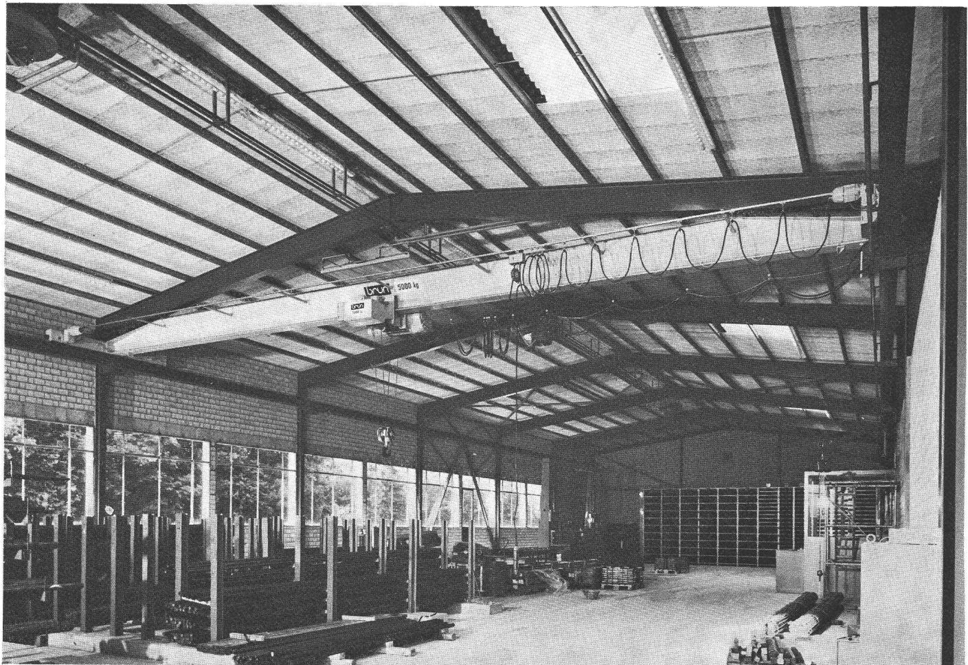
Les pont-roulants monopoutres standard BRUN sont entièrement exécutés avec des éléments normalisés de notre propre fabrication.
