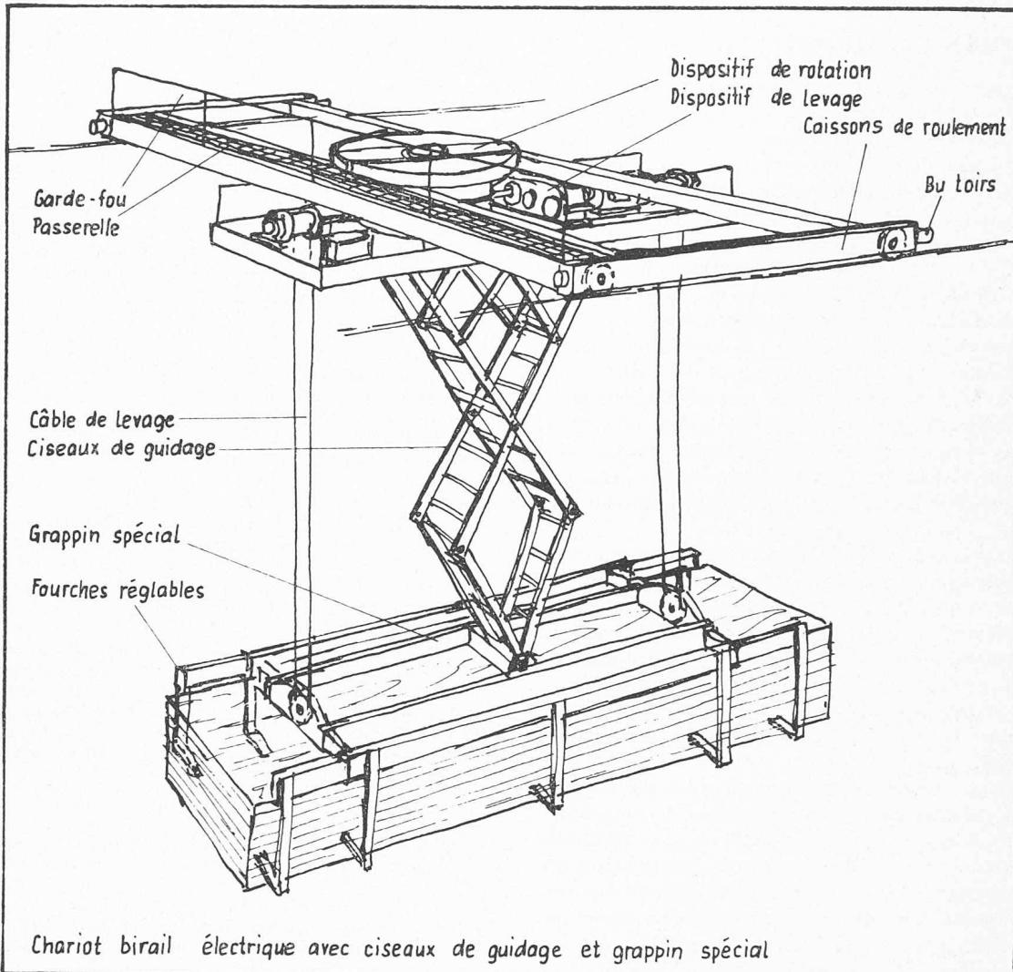
150 m/min sans à-coup. Le pont est également équipé d'une passerelle permettant l'accès à la cabine ainsi que la révision des différents organes.
