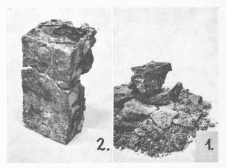
Fig. 4. — Photos d'éprouvettes des bétons 1 et 2 soumis à 225 cycles de gel-dégel en présence de sel. à gauche béton 2 à droite béton 1
