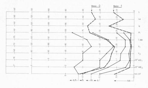
Fig. 1. — Diagramme de classement du béton en ce qui concerne sa résistance au gel en présence de sel.
