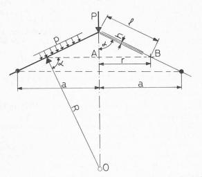
Fig. 11. — Stabilité élastique d'une coque conique de révolution chargée axialement en son sommet, ou soumise à une pression uniforme.
