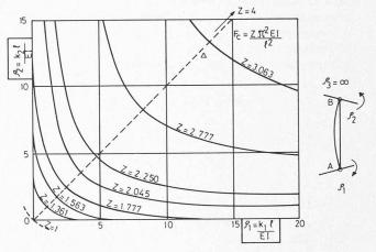
Fig. 4. — Abaque nº 1 de M. C. Bourdon, pour le flambement des barres semi encastrées (sans déplacement transversal relatif des appuis par rapport à la ligne moyenne — cas des barres de treillis).
