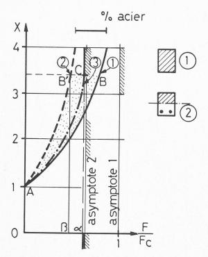
Fig. 14. — Coefficient d'amplification  $\chi$  des pièces en béton armé, en fonction du rapport  $F/F_c$ :
