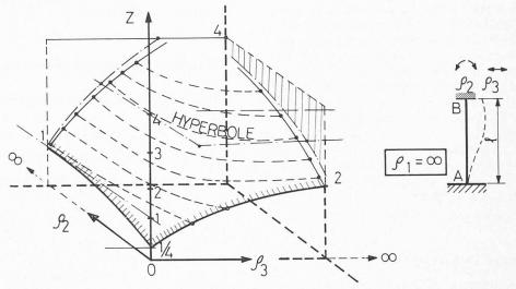
Fig. 3. — Surface caractéristique dans le cas d'un poteau encastré en pied.  $(Z=u^2/\pi^2)$
