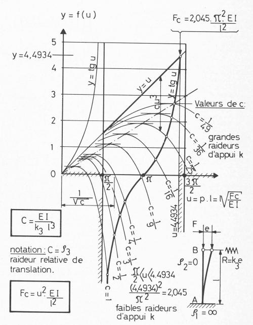
Fig. 19. — Poteaux encastrés en pied  $(\rho_1 = \infty)$  articulés en tête  $(\rho_2 = 0)$ , et soumis à une réaction élastique horizontale.  $tg \ u = u - c \ u^3$
