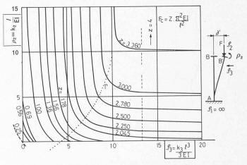
Fig. 5. — Abaque nº 2 de M. C. Bourdon pour le flambement de poteaux parfaitement encastrés en pied, et pouvant subir en tête un déplacement transversal et une rotation :
