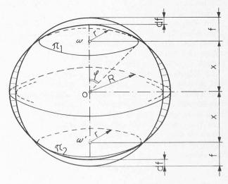
Fig. 12. — Représentation schématique de la déformation libre d'une coque sphérique soumise à une pression extérieure, dans le phénomène de cloquage :
