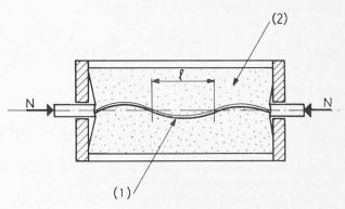
Fig. 10. - Modèle mécanique pour l'étude du flambement des tiges milieu élastique, et du cloquage :
